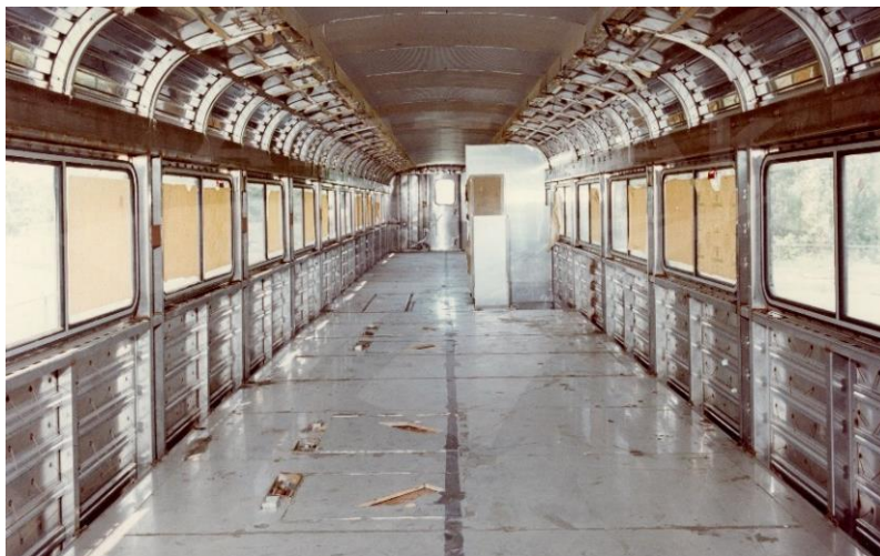
Рис. 2. Несуча конструкція кузова вагона Superliner
