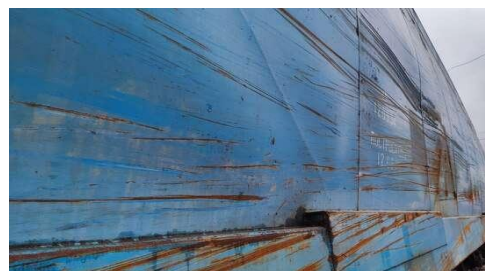
Рис. 6. Пошкодження обшивки бокової
