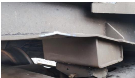
Рис. 7. Пошкодження нижньої полки шворневої балки
