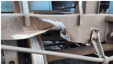
Рис. 3. Пошкодження кінцевої балки
