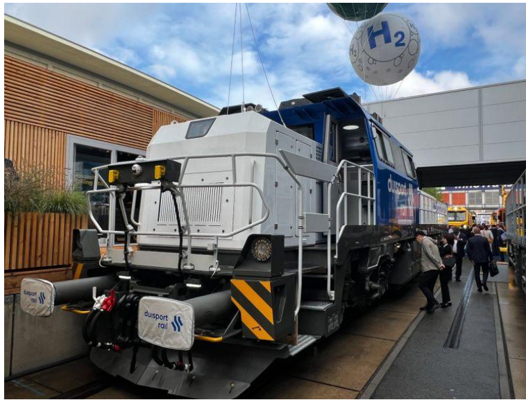
Рис. 5. Локомотив на акумуляторно-водневих паливних елементах Modula BFC
