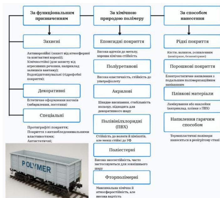
Рис. 1. Класифікація полімерних покриттів для несівних складових вантажних вагонів
