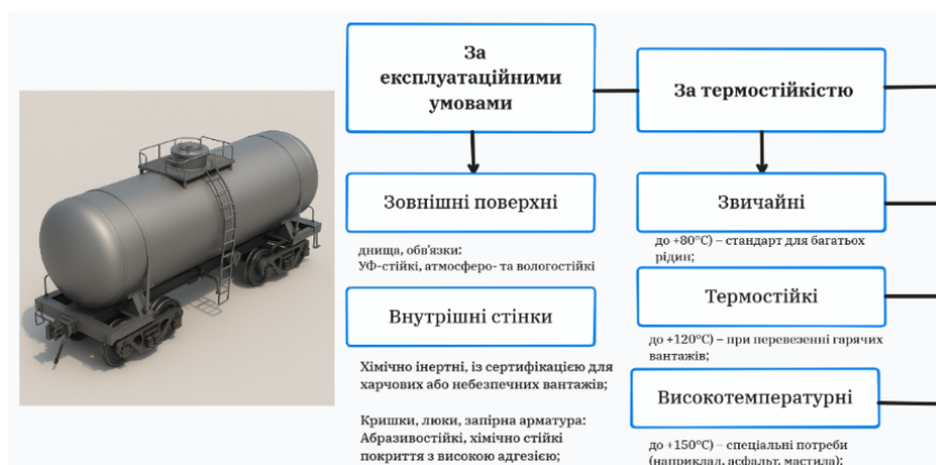
Рис. 2. Класифікація полімерних покриттів для несівних елементів вагона-цистерни
