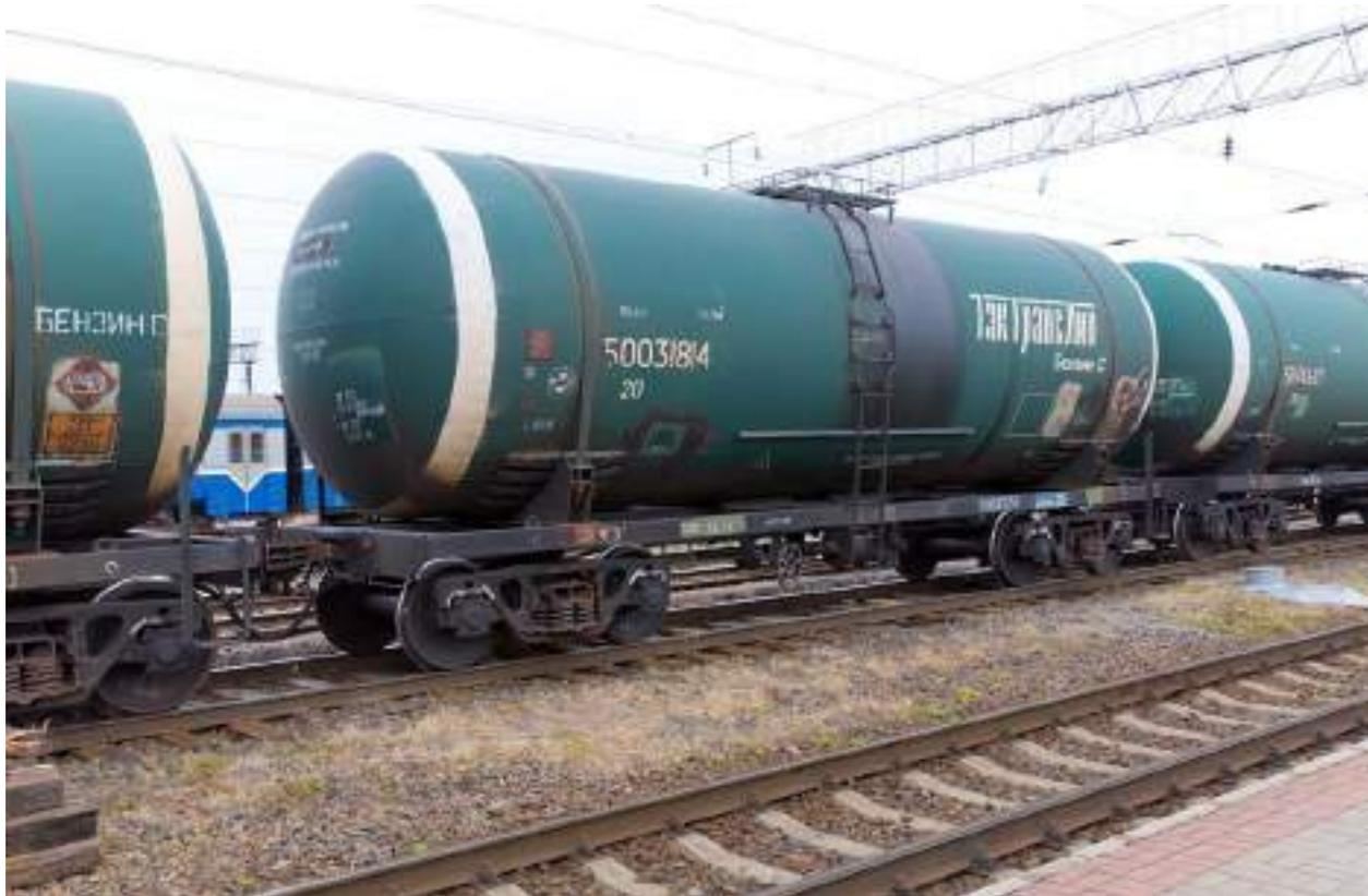
Рисунок 12.1 – Вагон-цистерна для бензина и нефтепродуктов модели 15-9049
