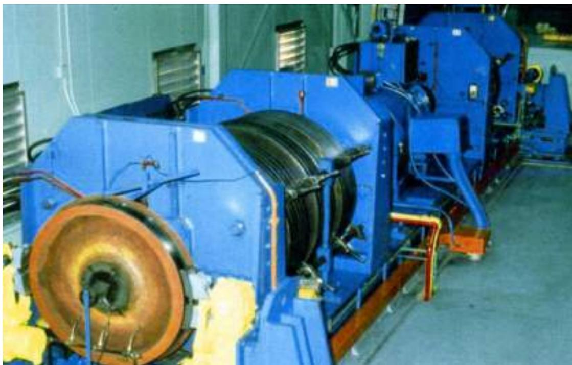
Рисунок 4.1 - Инерционный стенд для испытания колодок
