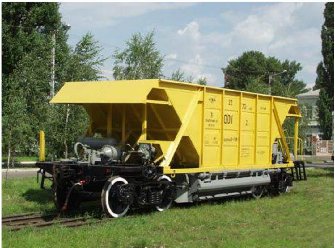
Рисунок 1.7 - Хоппер-дозатор
