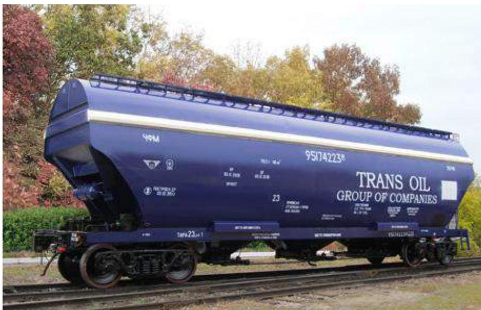
Рисунок 1.5 - Бункерный вагон для перевозки зерна
