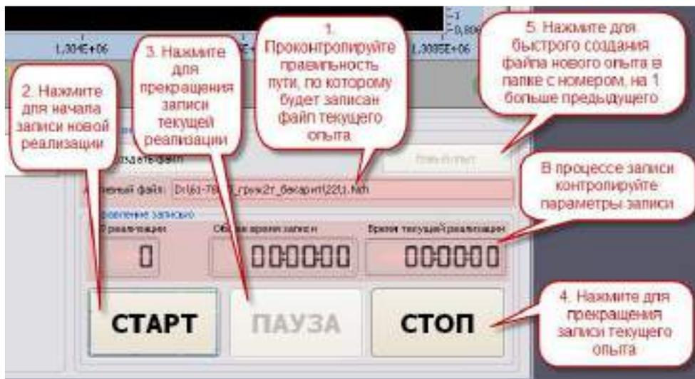
Рисунок 6.10 - Интерфейс для непосредственного управления процессом записи сигнала
