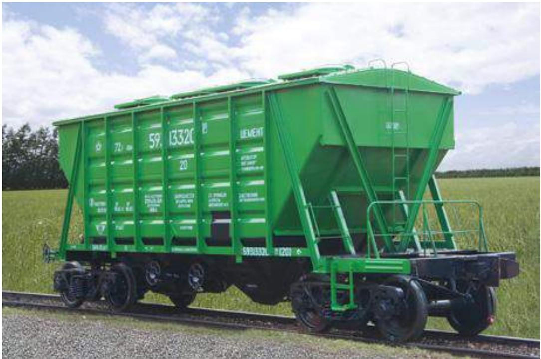
Рисунок 1.6 - Бункерный вагон для перевозки цемента
