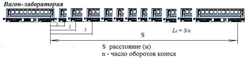
Рисунок 6.7 - Методика определения фактической длины окружности колеса
