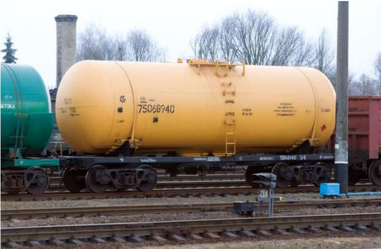
Рисунок 1.3 – Четырехосная цистерна модели 15-1547
