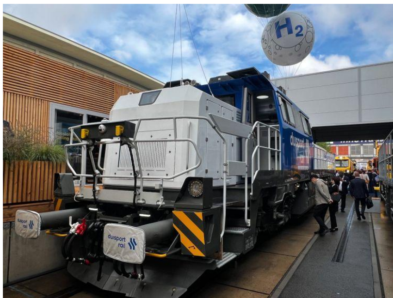
Рис. 3. Локомотив на акумуляторно-водневих паливних елементах Modula BFC
