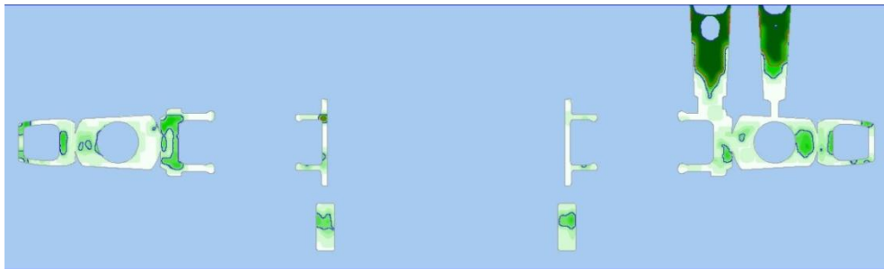
Рис. 5. Усадка в тепловых узлах (а) і розподіл величин критерію Ніями (б) в перерізі III-III
