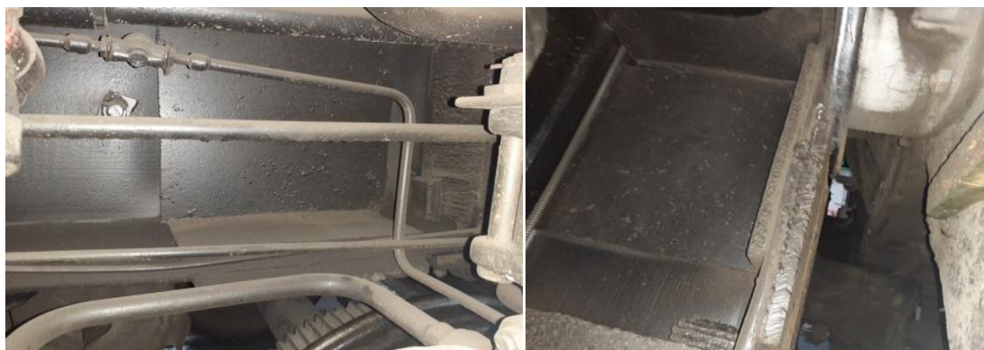
Рис. 2. Дефекти несної конструкції тепловоза:
