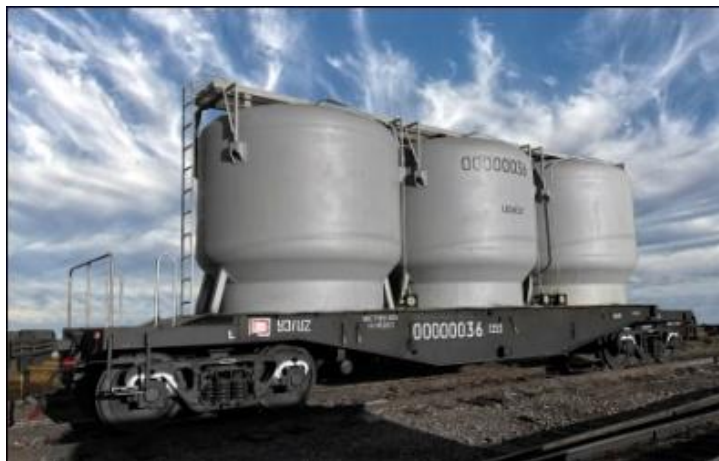
Рис. 1. Загальний вид вагона для цементу бункерного типу моделі 17-1890
