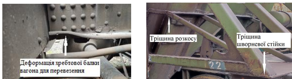
Рис. 4. Деформації та тріщини елементів конструкції зерновозів
