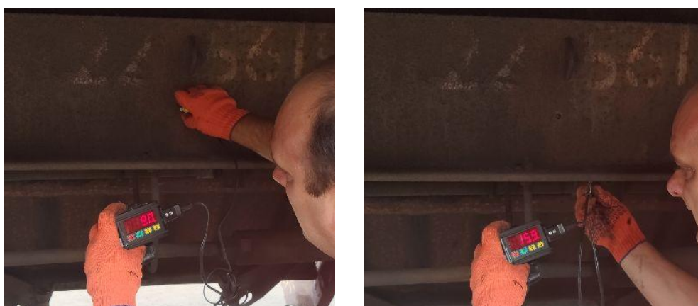
Рис. 1. Процес заміру фактичної товщини хребтової балки вантажного вагона
