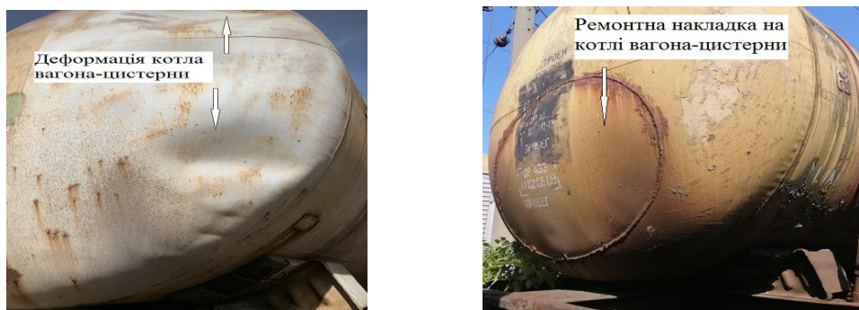
Рис. 5. Деформації та ремонтна накладка на котлі вагона-цистерни
