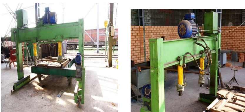
Рис. 11. Стенд рихтування люків напіввагонів
