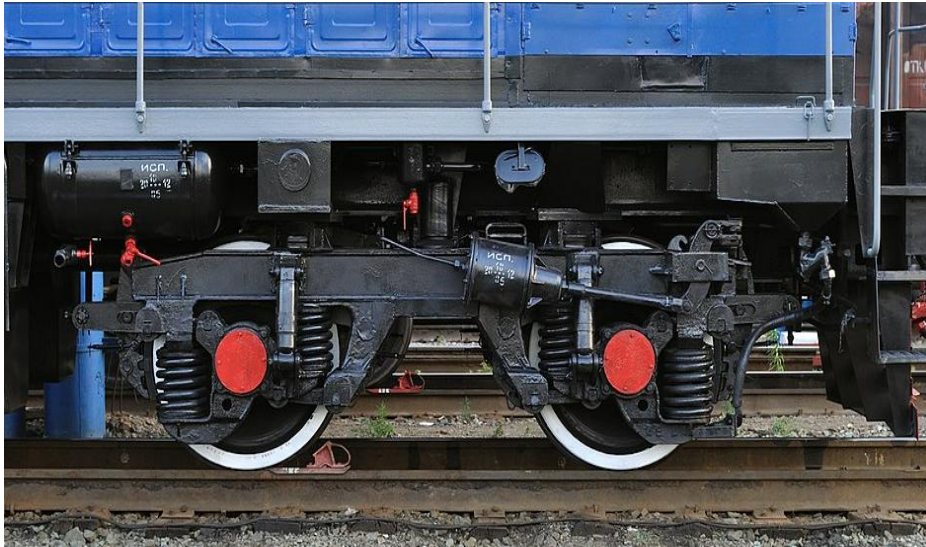
Рис. 2. Візок безщелепного типу тепловоза ТГМ6Б
