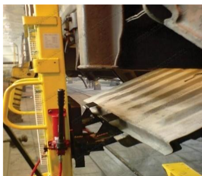
Рис. 8. Установка знімання-встановлення кришок люків напіввагонів
