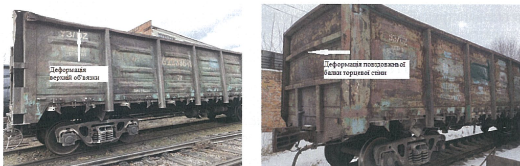
Рис. 3. Пошкодження не несних елементів на піввагонів
