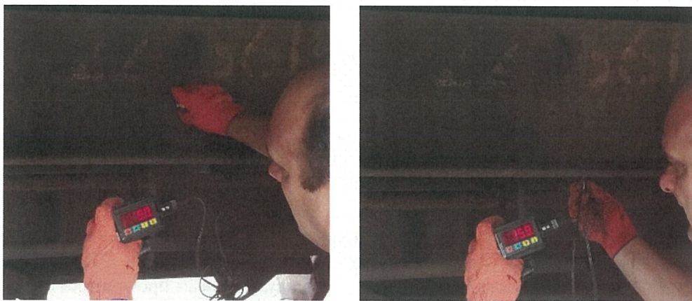
Рис. 1. Процес заміру фактичної товщини хребтової балки вантажного вагона
