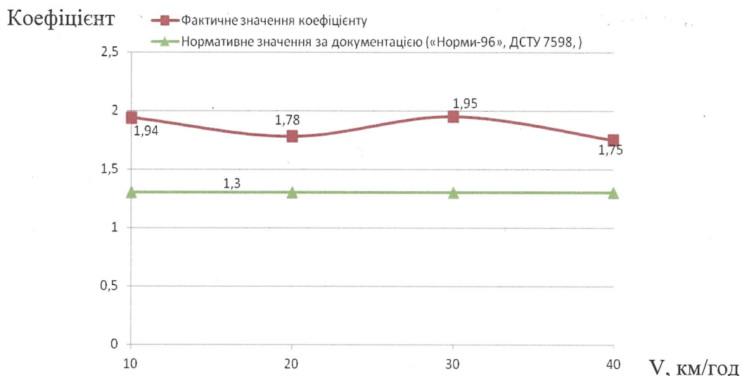
Рис.7. Ходові динамічні випробування вагона на коліях промислового транспорту у завантаженому режимі
