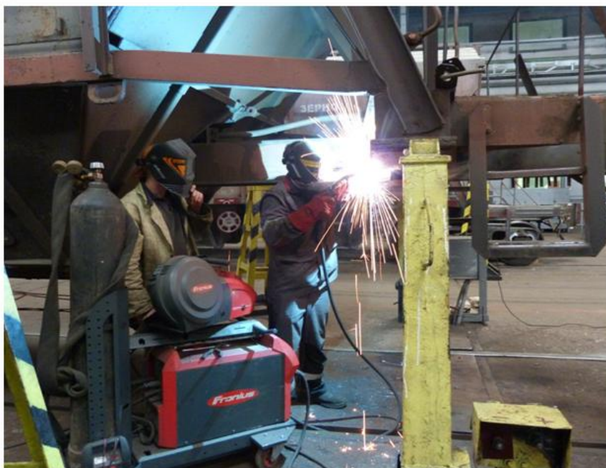
Рис.1. Процес проведення модернізації рами кузова вагона-зерновоза
