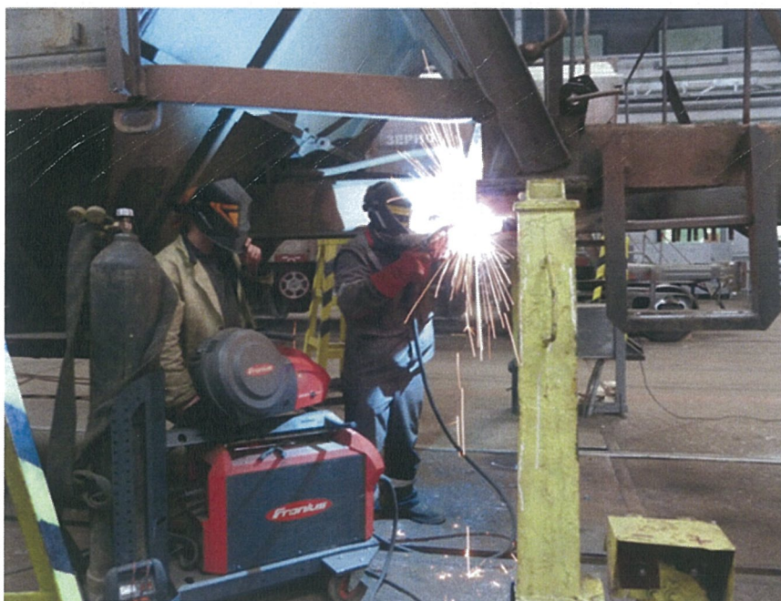
Рис. 1. Процес проведення модернізації рами кузова вагона-зерновоза
