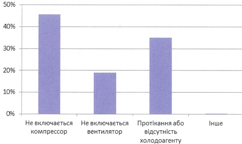
Рис. 6. Розподіл пошкоджень системи охолодження
