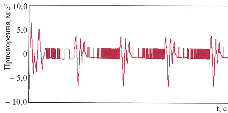
Рис. 4. Прискорення несучої конструкції вагона-платформи в зонах спирання на візки під час руху у порожньому стані
