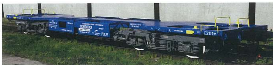
Рис. 5. Вагон-платформа моделі 13-6954 (з візками моделі 18-6960)
