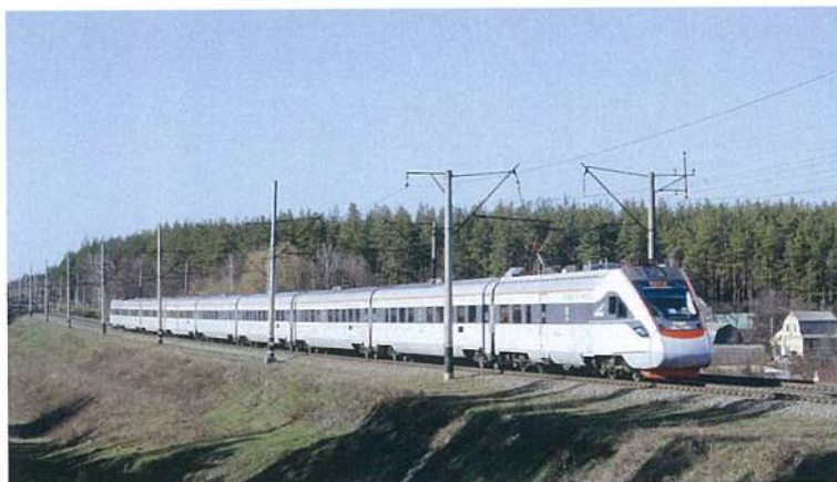
Рис. 1. Зовнішній вигляд межрегіонального швидкісного двосистемного електропоїзда Екр1
