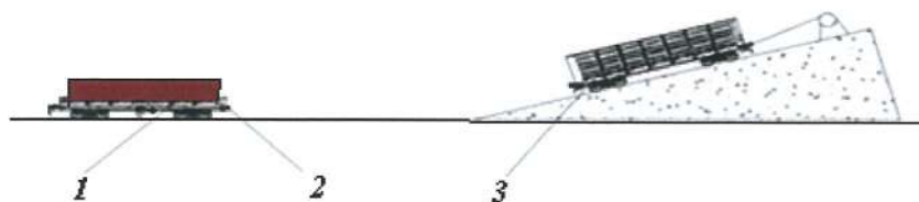
Рис. 2. Схема розташування вагонів при проведенні ударних випробувань: 1 - вагон, який випробовують; 2 - тензометричний автозцеп; 3 - вагон-бойок
