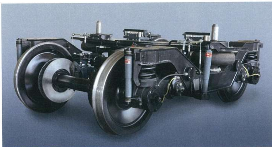
Рис. 8. Візок з дисковим гальмом і ресорним пневмопідвішуванням
