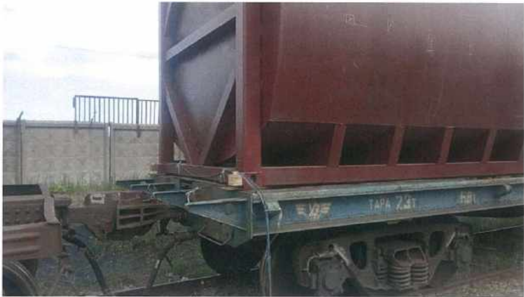
Рис. 6. Віброперетворювачі, встановлені на передніх фітингах
