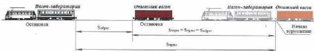
Рис. 1. Ходові гальмівні випробування вантажного вагона методом «кидання»
