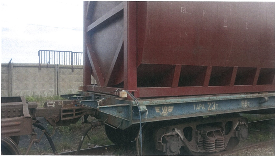
Рис. 6. Віброперетворювачі, встановлені на передніх фітингах
