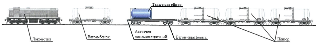
Рис. 4. Схема розташування вагонів при випробуваннях на співудар
