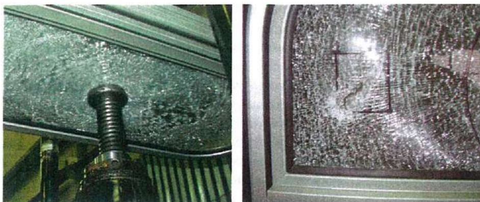
Рис. 4. Випробування на характер руйнування скла кватирки вікна пасажирського вагона
