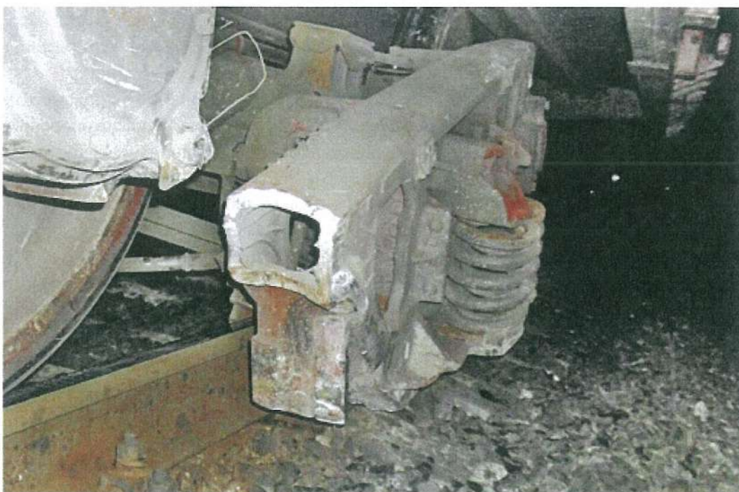
Рис. 5. Приклади втомних руйнувань рам бокових в експлуатації
