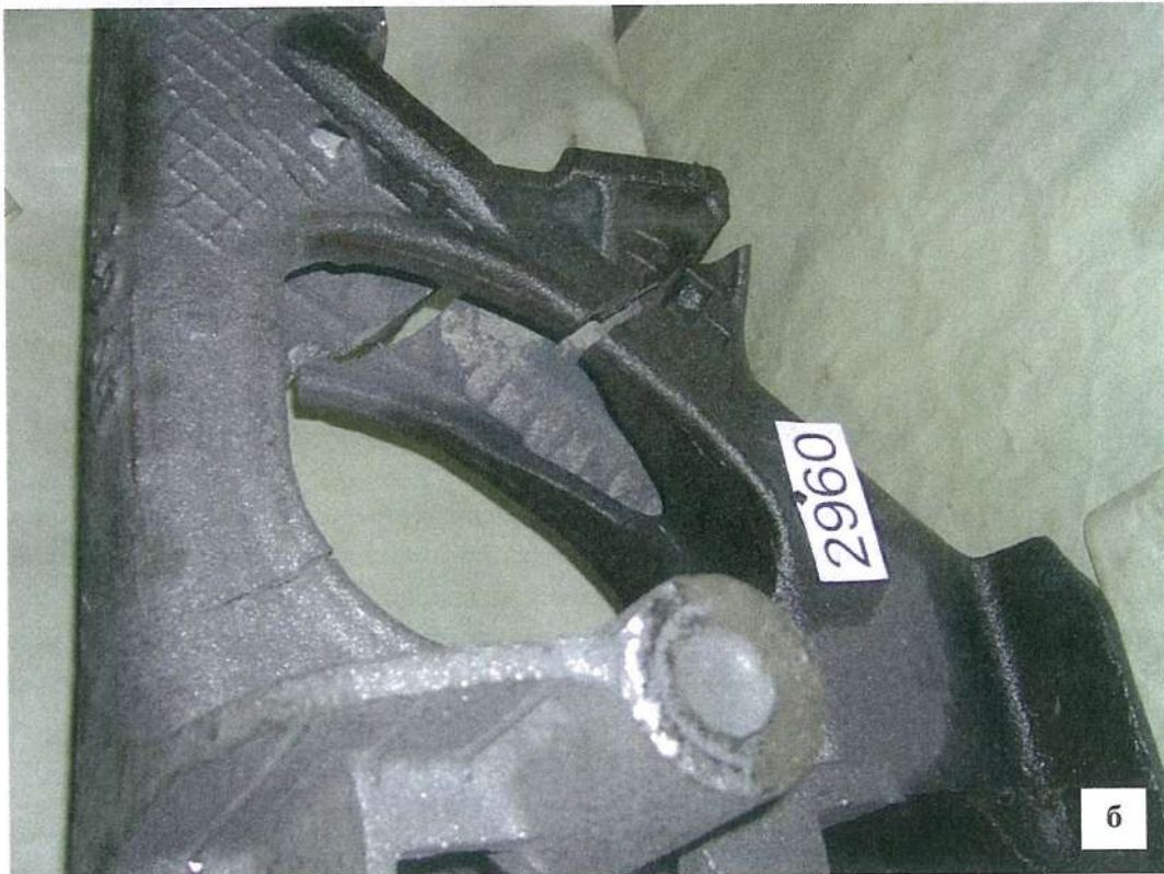
Рис. 10. Види втомного руйнування (а) та зламу (б) рами бокової № 2960, яку виготовлено у 2005 році
