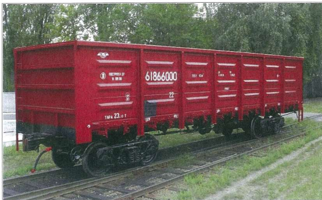
Рис. 2. Полувагон модели 12-7023 на тележках модели 18-7020 с нагрузкой от колесной пары на рельс 23,5 тс
