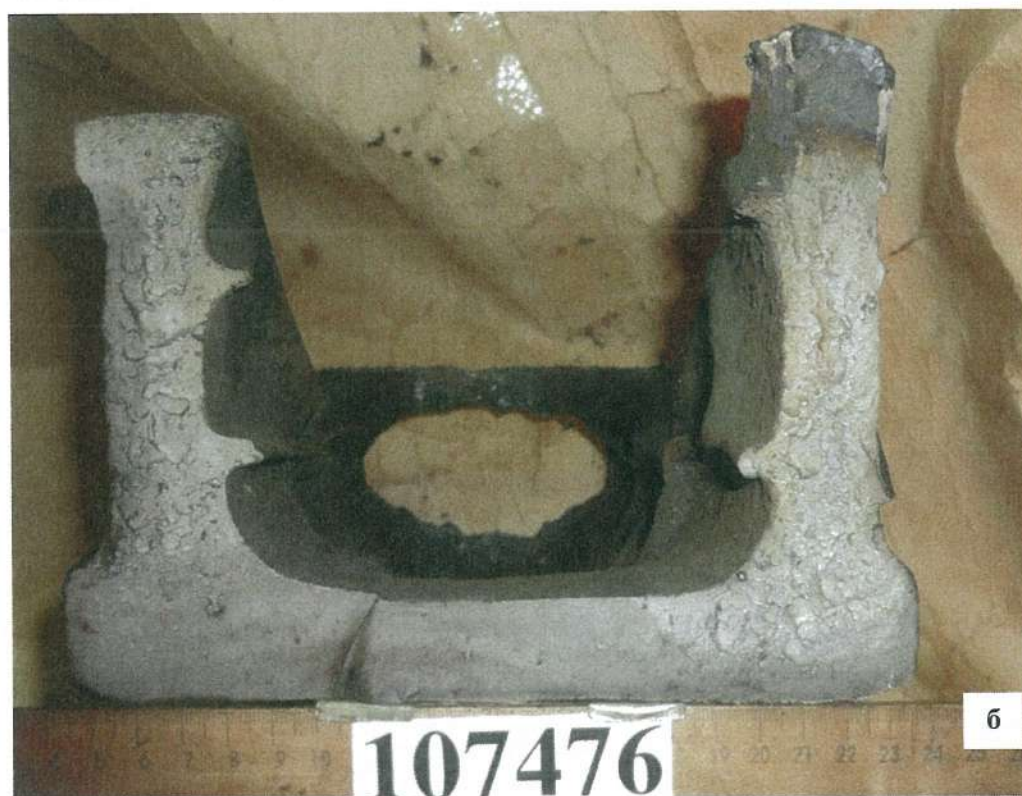
Рис. 8. Види втомного руйнування (а) та зламу (б) рами бокової № 107476, яку виготовлено у II півріччі 2012 року
