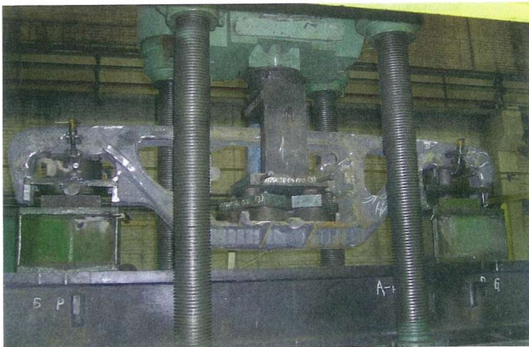
Рис. 6. Стенд ЦДМ-200 Пу для випробувань на втому рами бокової
