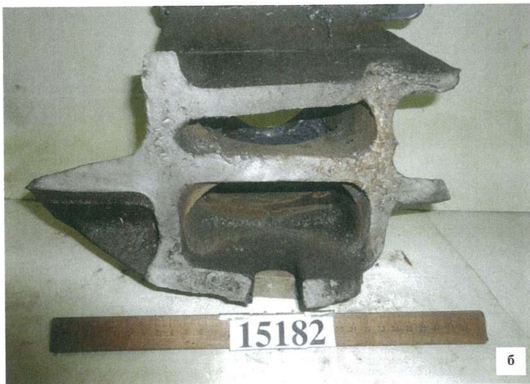
Рис. 9. Види втомного руйнування (а) та зламу (б) рами бокової № 15182, яку виготовлено у I півріччі 2012 року
