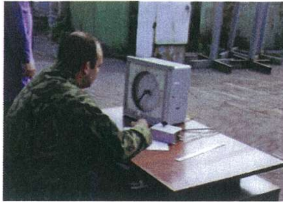
Рис. 6. Реєстрація показів термоелектричних перетворювачів під час випробувань
