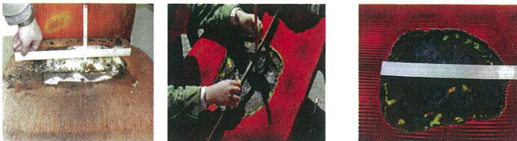
Рис. 8. Визначення фактичних розмірних характеристик пошкоджених поверхонь елементів макетів пасажирського купе та відсіку пасажирського салону відкритого типу
