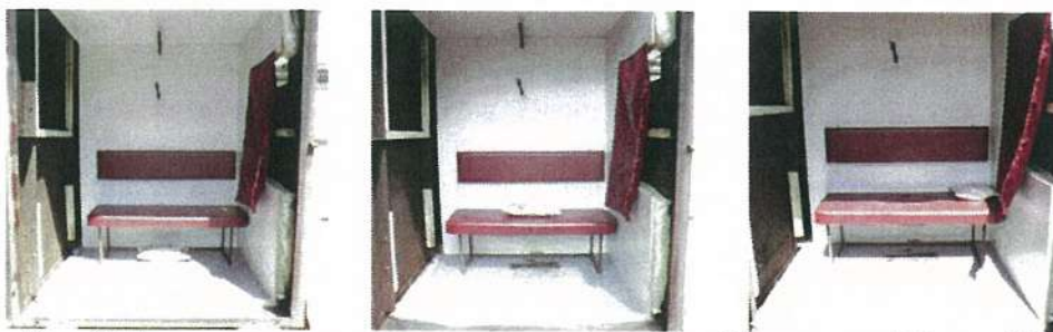
Рис. 3. Розташування джерел запалювання (робочих пакетів) в найбільш пожежонебезпечних зонах макета купе пасажирського вагона
