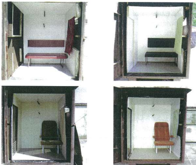
Рис. 1. Макети пасажирських купе та відсіків пасажирських салонів вагонів відкритого типу в камері перед випробуванням
