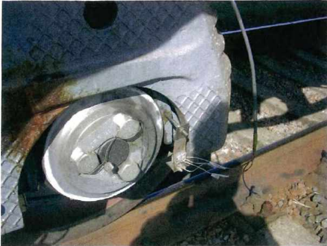
Рис. 3 – Монтаж датчика для вимірювання горизонтальних буксових переміщень візка моделі 18 - 4129.
