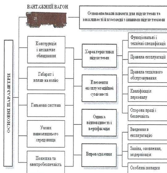
Рис. 3. Структура ТСІ для підсистеми «Вантажні вагони»
