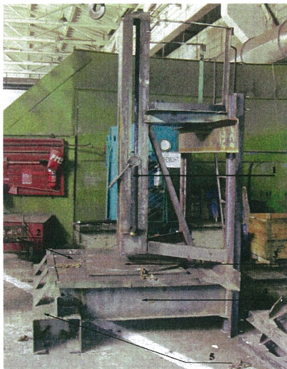
Рис. 1. Образец стенда для испытания крышек люков на ПАО «Дизельный завод», ИКЛ 270.00.000, зав. № 007
