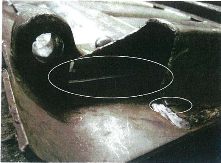
Рис. 13. Испытуемый образец № 2 – трещина боковой обвязки крышки люка в зоне петли длиной до 100 мм
