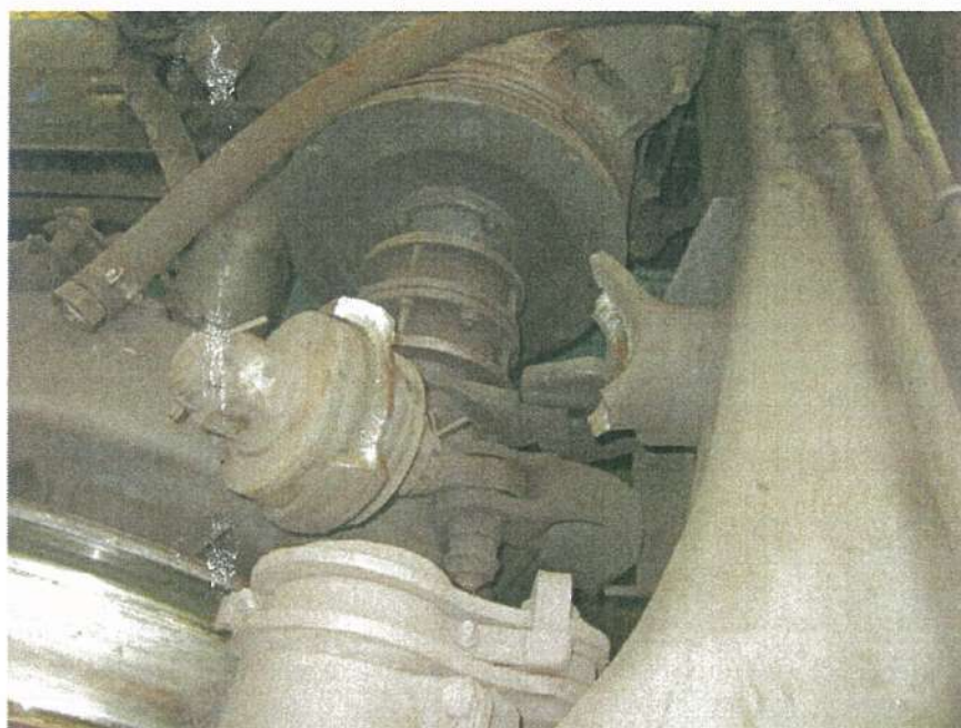
Рис. 2. Излом кронштейна подвески редуктора тележки типа Е
