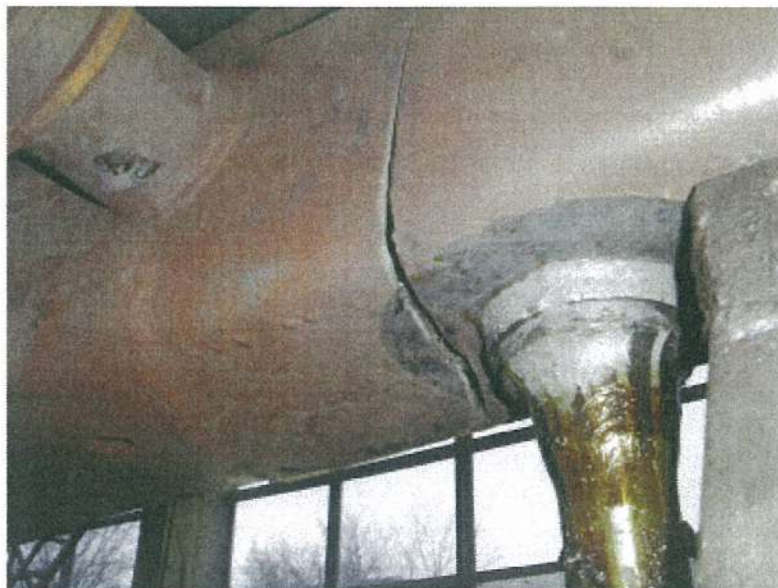
Рис. 4. Излом продольной балки рамы тележки шпинтонного типа вагона метрополитена
