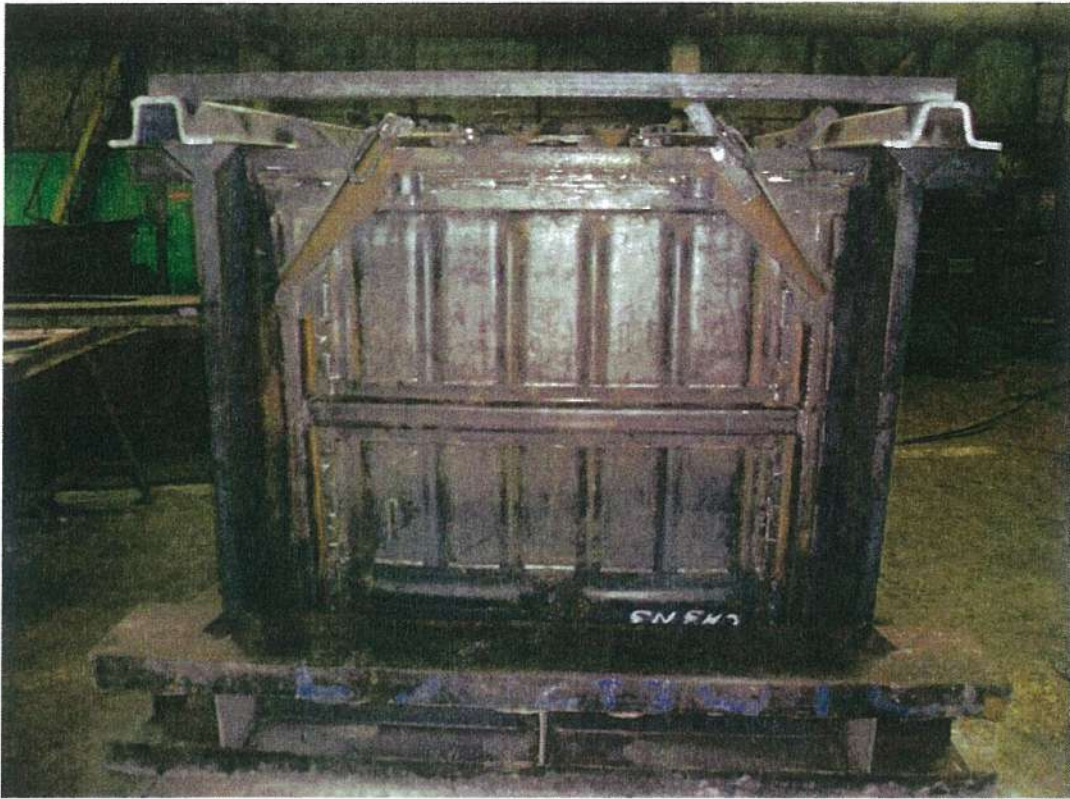
Рис. 3. Стенд в момент проміжучого огляду кришки люка, встановлений в комісійне положення
