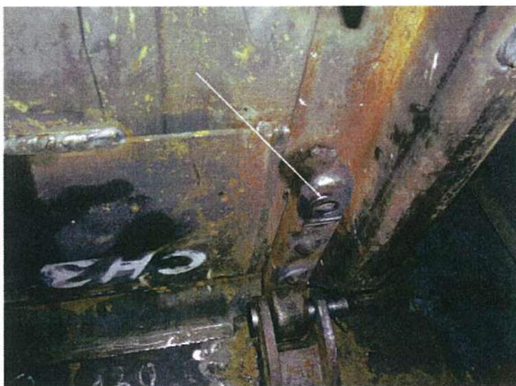
Рис. 9. Испытуемый образец № 1 – выпала оборванная ранее заклепка (фото - вид снизу)
