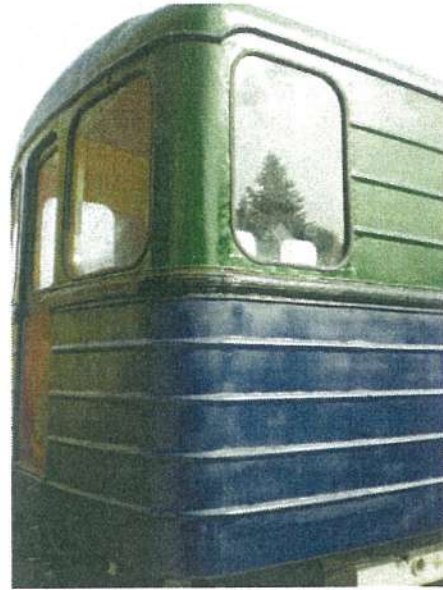
Рис. 3. Дверь кабины машиниста после проведенных работ
