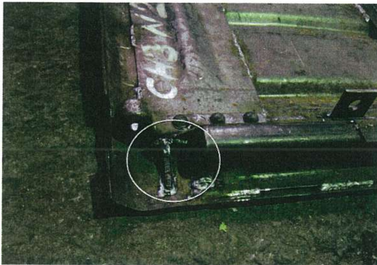
Рис. 14. Испытуемый образец № 2 – после проведения ремонта
