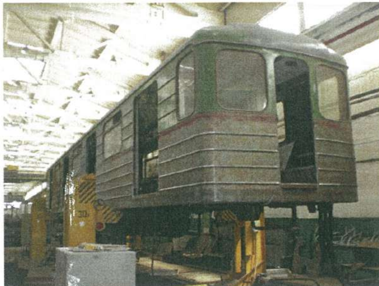
Рис. 1. Процесс окраски кузова вагона
