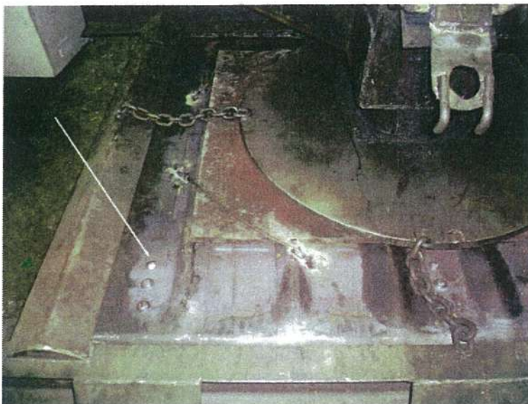
Рис. 8. Испытуемый образец № 1 – обрыв головки заклепки
