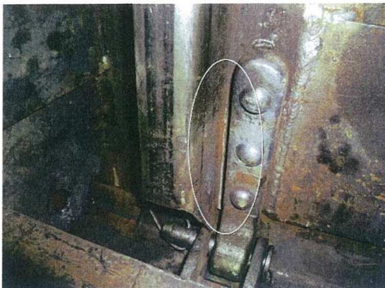
Рис. 10. Испытуемый образец № 1 – трещина боковой обвязки крышки люка в зоне петли длиной 140 мм (фото - вид снизу)
