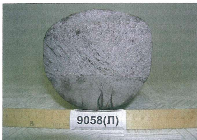
Рис. 2. Характерный вид изломов разрушенных образцов осей
