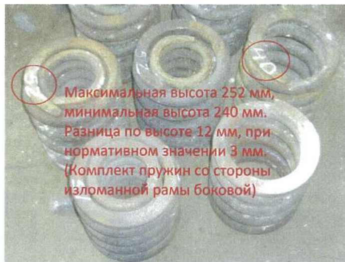
Рис. 2. Разница высот пружин в одном рессорном комплекте
