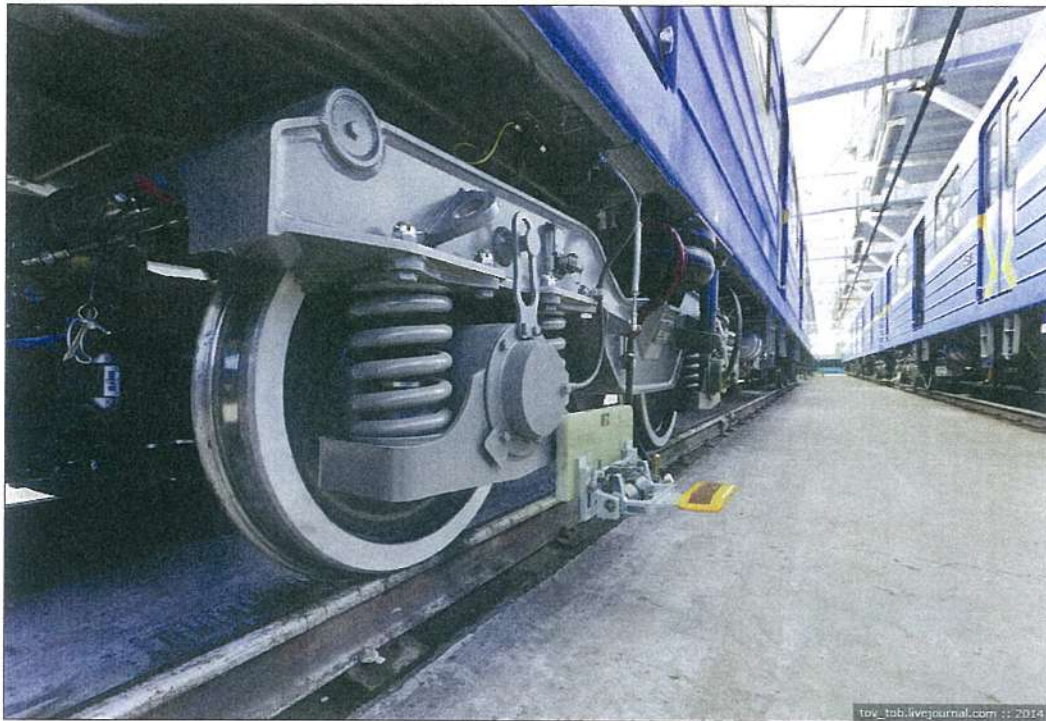
Рис. 4. Датчик обертів колеса, встановлений на осі колісної пари вагона метро
