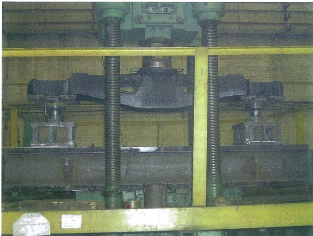
Рис. 1. Вигляд стенду ЦДМ-200 Пу для випробувань на втому зі встановленою балкою надресорною
