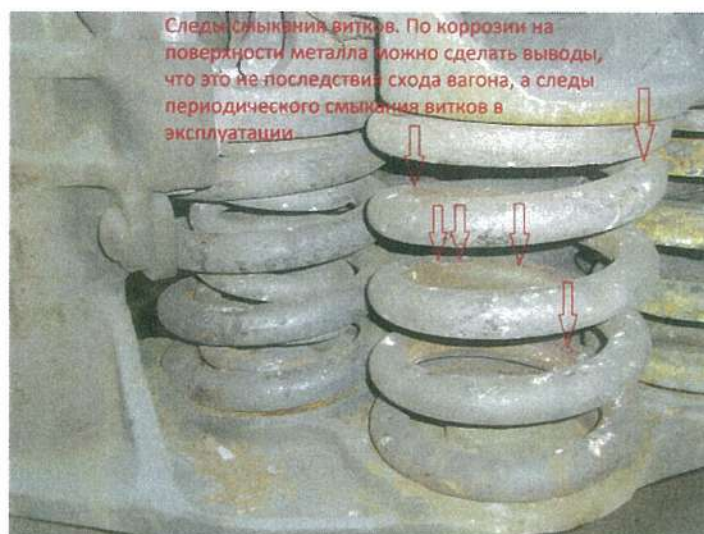
Рис. 3. Следы смыкания витков пружин
