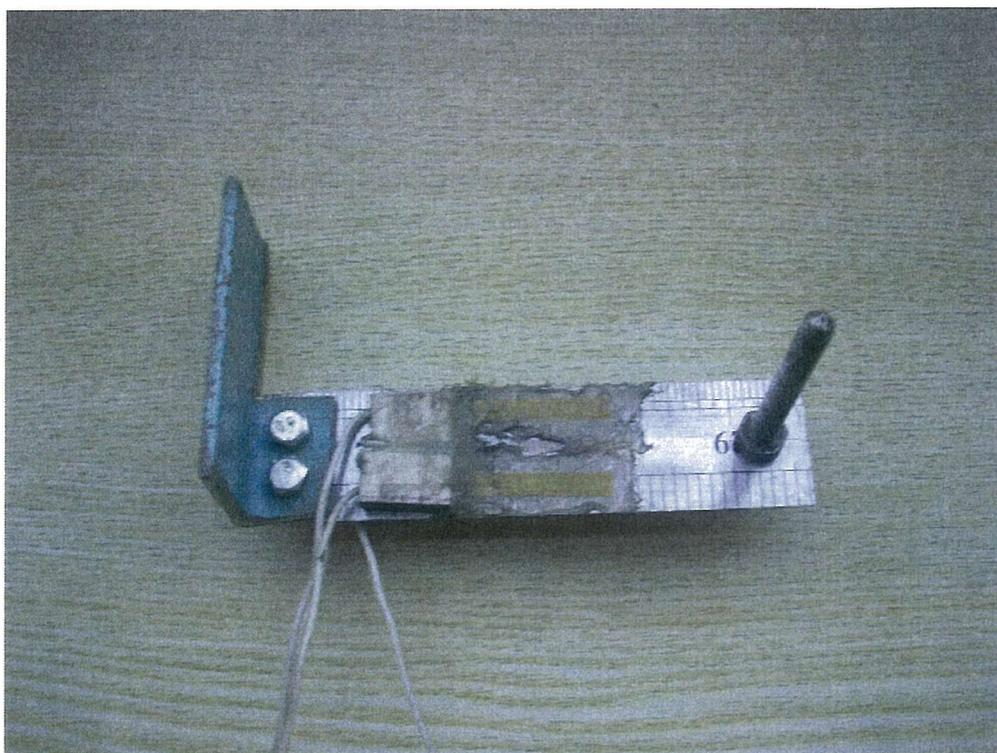
Рис. 1 – Зовнішній вигляд датчика для вимірювання переміщень ( $0 \div \pm 5\text{мм}$ ).
