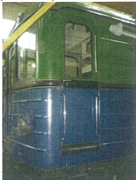
Рис. 2. Дверь кабины машиниста до демонтажа
