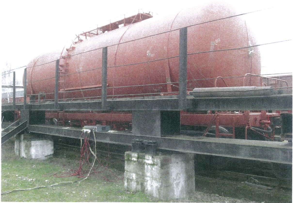
Рис. 2. Вагон-цистерна моделі 15-776Э в стенді розтягнення-стискання
