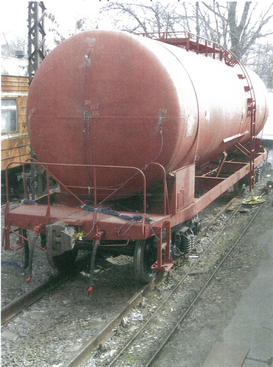
Рис. 3. Вагон-цистерна моделі 15-776Э в стенді «гірка»
