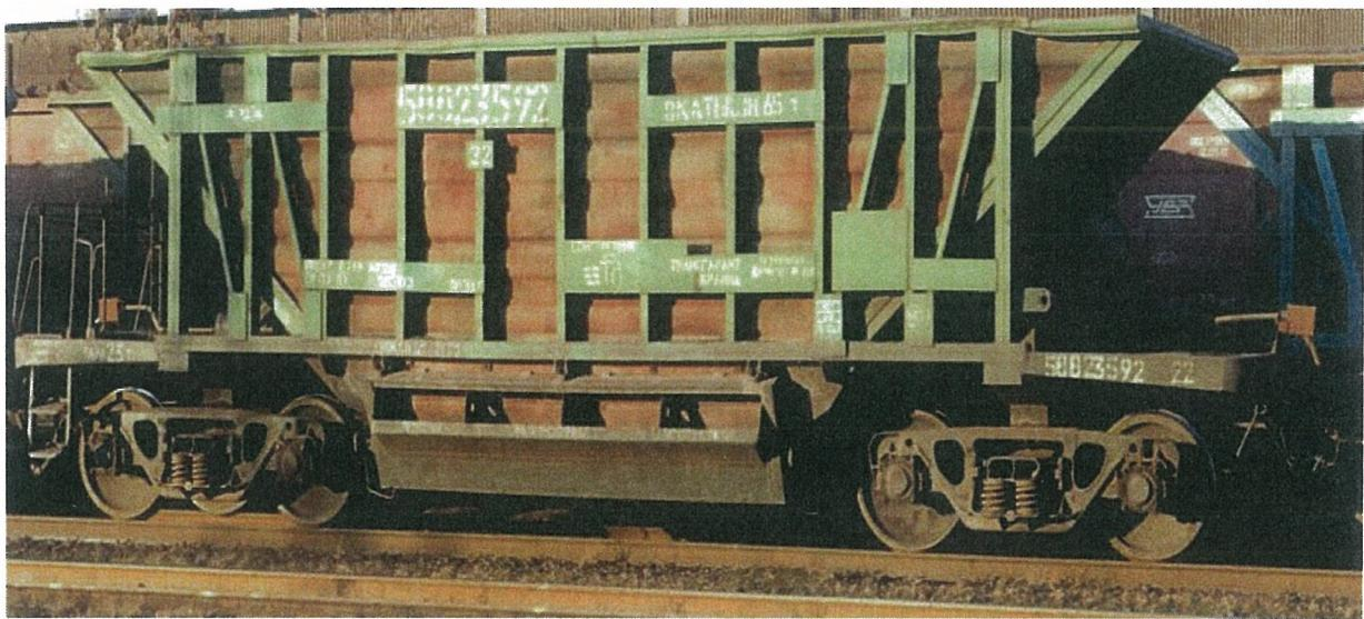
При проведенні технічного діагностування особу увагу привертають несучим елементам конструкції, а саме хребтовій та шворневій балкам та місцям їх з'єднання.
