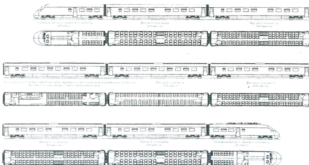
Рис. 1. Схема двухсистемного электропоезда для межрегионального сообщения
