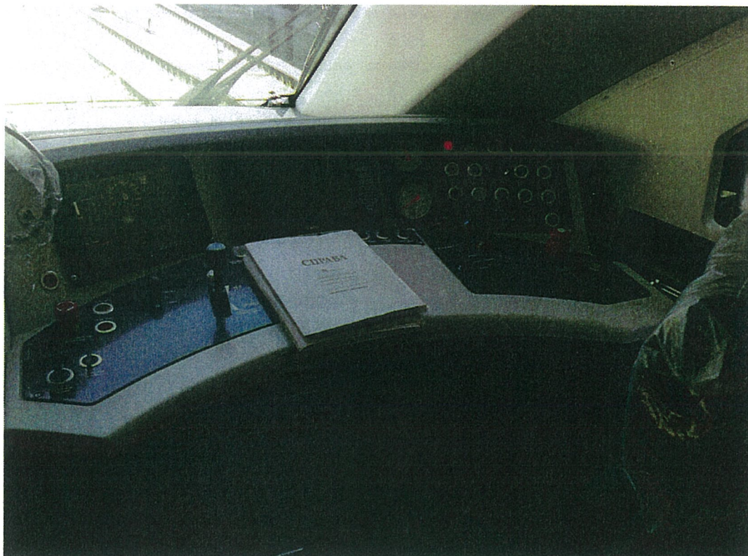
Рис. 4. Кабина машиниста: рукоятки и кнопки управления, дисплей отображения диагностической информации
