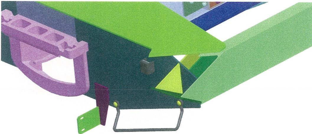
*Рис. 4. Консольная часть вагона модели 13-4147 (разрез боковой балки в районе установки упора под. контейнер) 2-го варианта конструкции*
