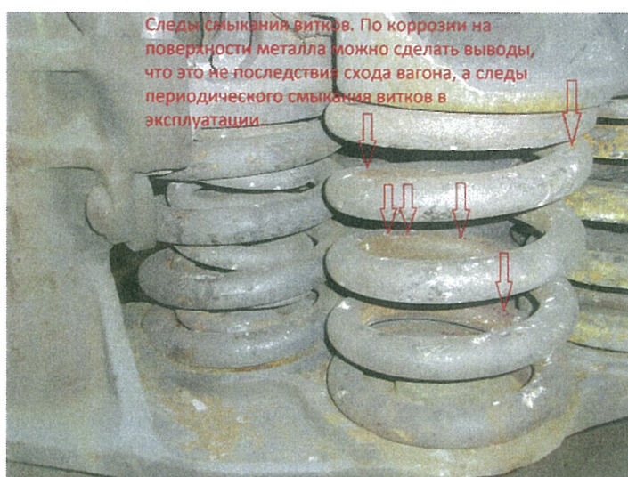
Рис. 3. Следы смыкания витков пружин
