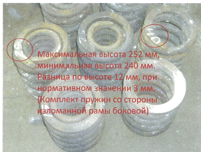
Рис. 2. Разница высот пружин в одном рессорном комплекте
