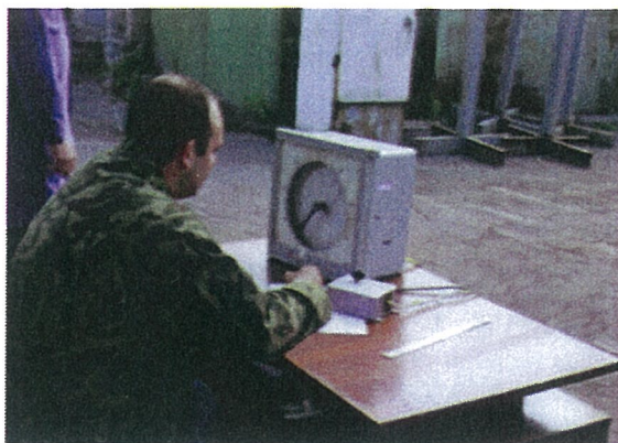
Рис. 6. Реєстрація показів термоелектричних перетворювачів під час випробувань
