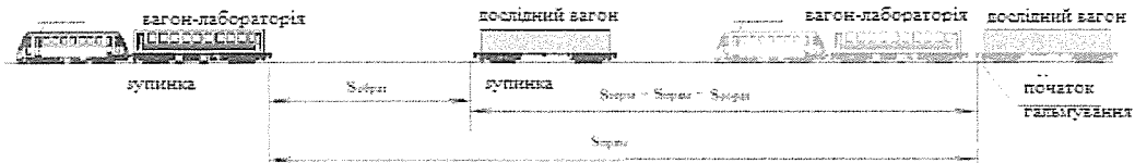
Рис. 2. Визначення гальмівного шляху дослідного вагона методом «кидання»
