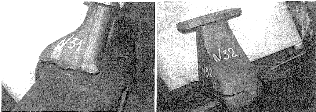
Рис. 5. Типове пошкодження кронштейнів буксових повідків
