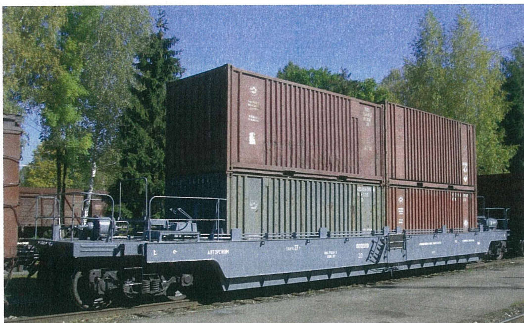
Рис. 2. Загальний вид вагона-платформи для перевезення великотоннажних контейнерів в два яруси
