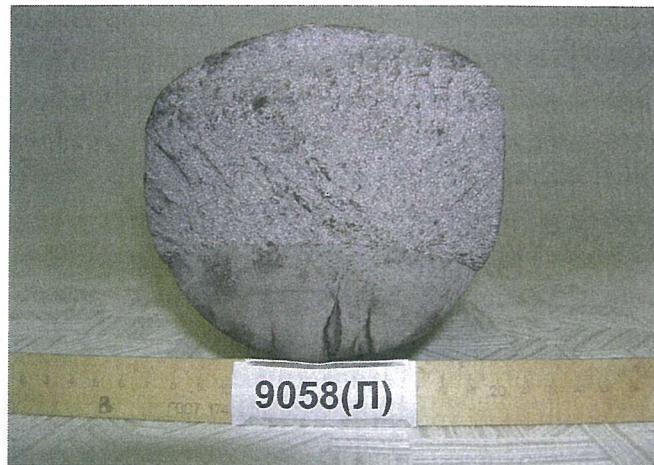
Рис. 2. Характерный вид изломов разрушенных образцов осей
