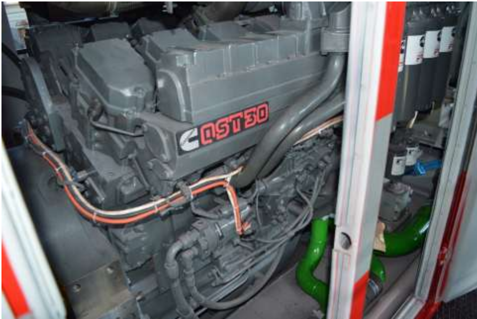
Рис. 2. Дизель Cummins QST-30 встановлений на модернізований тепловоз ТГМ4-1890 для ПАТ «Запоріжсталь»
