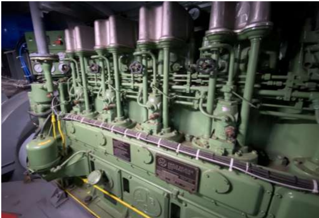
Рис. 6. Двигун 8DZC-1000-188-К виробництва Anglo Belgian Corporation встановлений на тепловозі 2ТЭ10М під час модернізації
