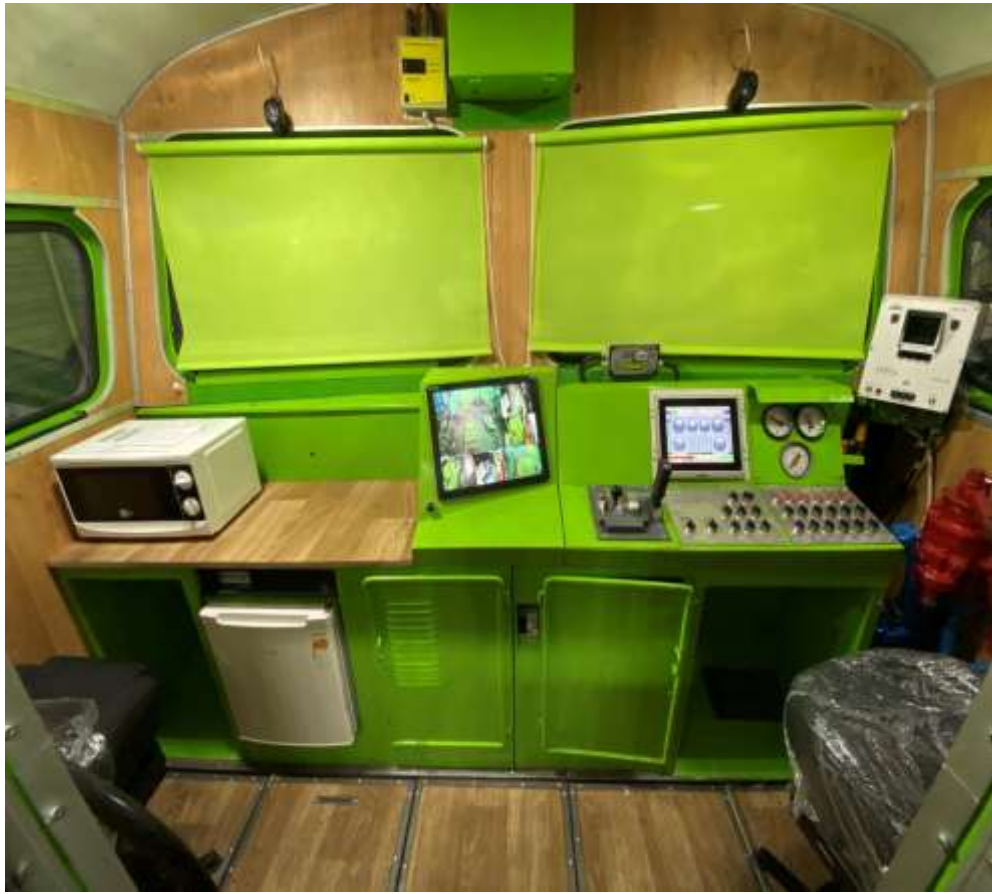
Рис. 7. Кабіна машиніста та пульт управління на тепловозі 2ТЭ10М після модернізації
