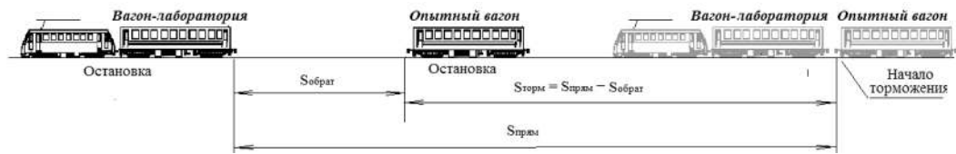
Рис. 1. Определение тормозного пути опытного вагона методом «бросания»
