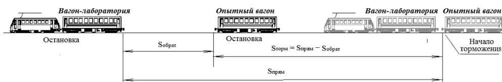
Рис. 1. Определение тормозного пути опытного вагона методом «бросания»
