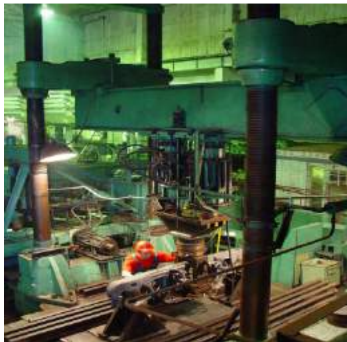
Рис. 11 - Установка бокової рами для випробування її на втому
