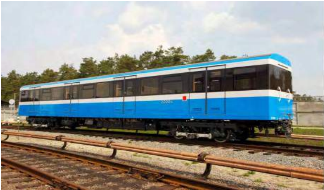
Рис. 43 - Проміжний вагон для метро (модель 81-7022)
