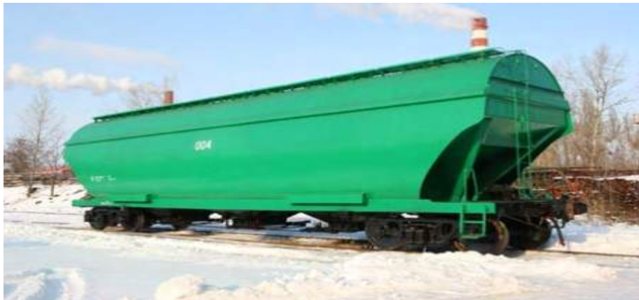
Рис. 50 - Вагон-хопер для сипких вантажів, модель 19-7053
