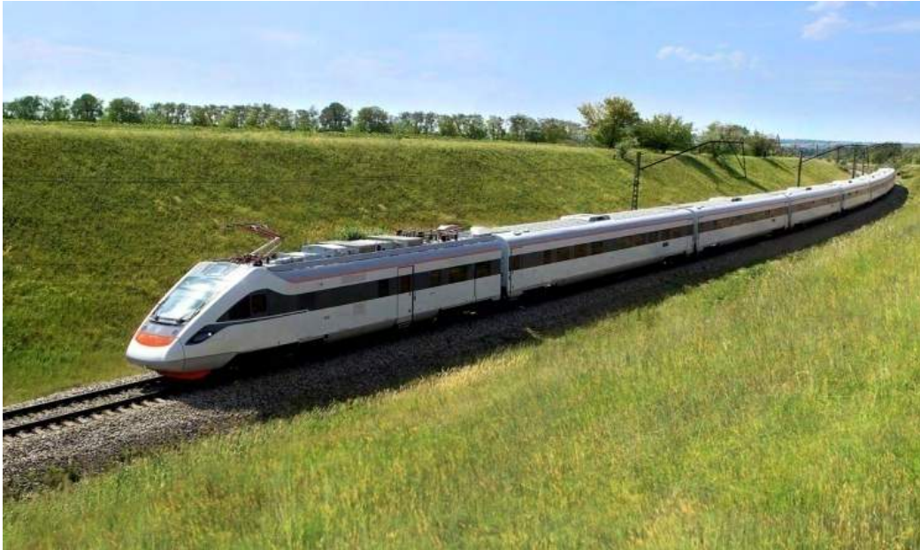
Рис. 52 - Двохсистемний електропоїзд виробництва ПАТ «КВБЗ»
