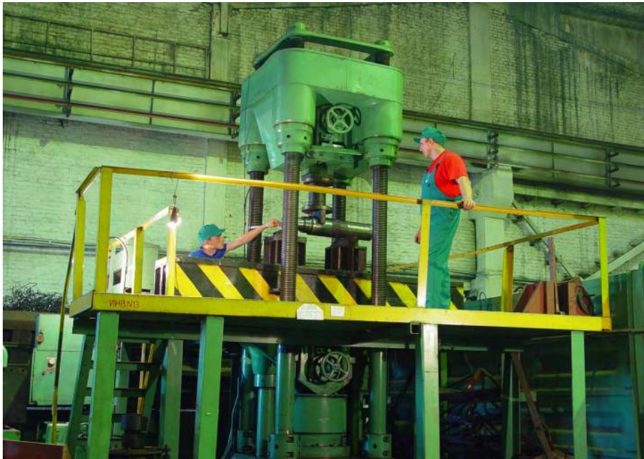
Рис.10 - Стенд для випробування деталей та вузлів на втому
