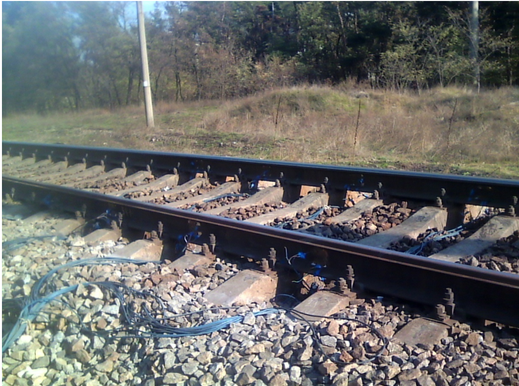
Рис. 2 - Загальний вигляд розташування тензорезисторів на дослідних ділянках залізничної колії
