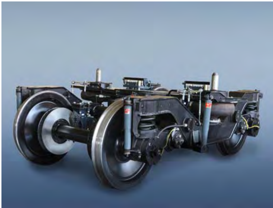
Рис. 53 - Візок пасажирського вагона з пневмопідвішуванням, модель 68-7047
