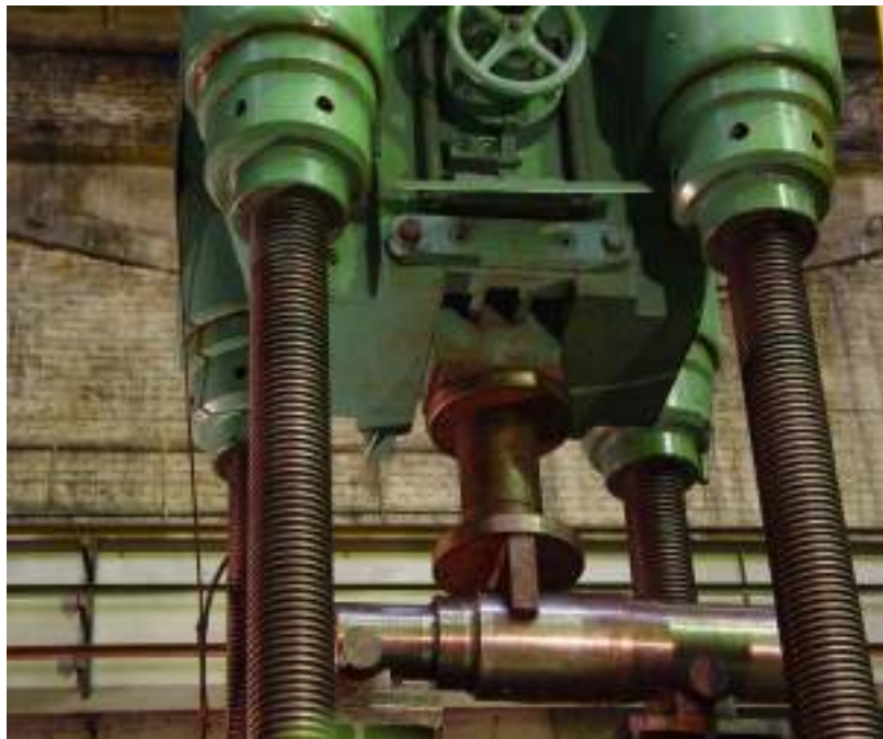
Рис.13 - Випробування осі вагонної на втому
