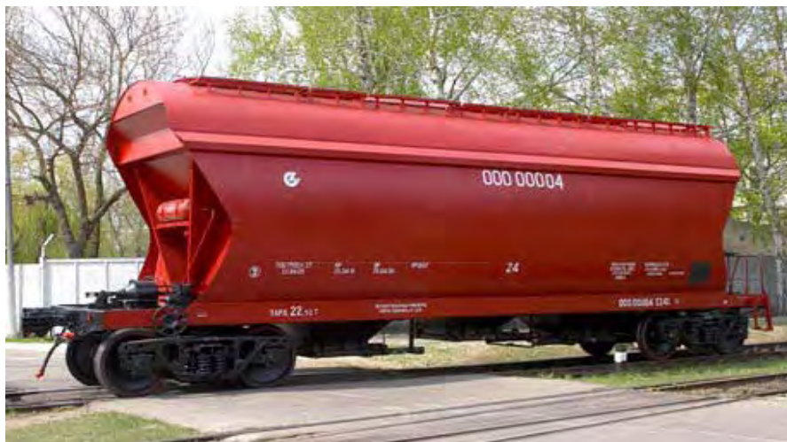
Рис. 51 - Вагон-хопер для зерна, модель 19-7017
