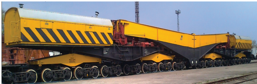
Рис. 6. Сочлененный транспортер грузоподъемностью 500 т постройки фирмы «Крупп» (Германия)
